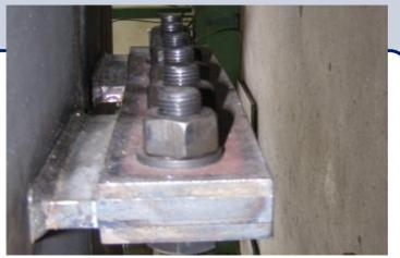
**拘束治具自体の剛性による溶接変形低減効果も期待される**
