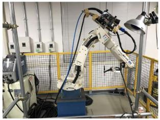
溶接ロボット Almega AII-V6
