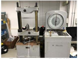
図 5 25 ton アムスラー型万能試験器
